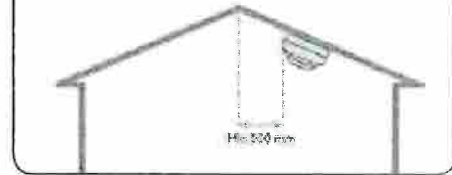
Bild 4. Placering av brandvarnare i snedtak.
