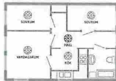
Bild 1. Placering av brandvarnare i enplanslägenhet.
